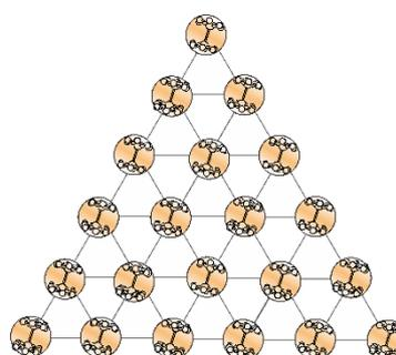
例えば、二量体が正三角形の頂点に配置する結晶  $(\text{C}_2\text{H}_5)(\text{CH}_3)_3\text{Sb}[\text{Pd}(\text{C}_3\text{S}_5)_2]_2$  では、磁性が定まらない性質（スピン液体）を示し、また、超伝導になりにくいことが知られています<sup>\*3</sup>。一方、二量体が正三角形から僅かにずれた条件に該当する結晶  $(\text{C}_2\text{H}_5)(\text{CH}_3)_3\text{As}[\text{Pd}(\text{C}_3\text{S}_5)_2]_2$  では、磁性を示す半導体とみなされており、しかも、三角形を歪めるだけで容易に超伝導になります。過去の研究では、各二量体に拘束された一個一個の価電子から生じる磁場の方向が、規則性を持って並ぶ（反強磁性<sup>\*4</sup>）ことで、価電子は動けず半導体になると考えられ、また、超伝導も反強磁性に由来すると考えられてきました。しかし、このような議論の前提となる、価電子の並び方や割り振りを調べた例はありませんでした。
