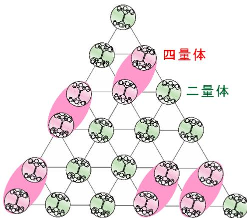
図2  $(\text{C}_2\text{H}_5)(\text{CH}_3)_3\text{As}[\text{Pd}(\text{C}_3\text{S}_5)_2]_2$  の二次元の三角形構造における価電子の配置される様子。一個一個の円は二個の錯体分子  $[\text{Pd}(\text{C}_3\text{S}_5)_2]_2$  から成る二量体。桃色の二量体からなる楕円は、二個が近寄ることのできた四量体。緑の二量体は四量体を形成しない二量体。緑の二量体は磁性に寄与するが、桃色の四量体は磁性に寄与しない。緑の二量体の二個の分子には、一個の価電子が等確率で存在する。四量体の四個の分子では、二個の価電子は異なる確率で存在する。
