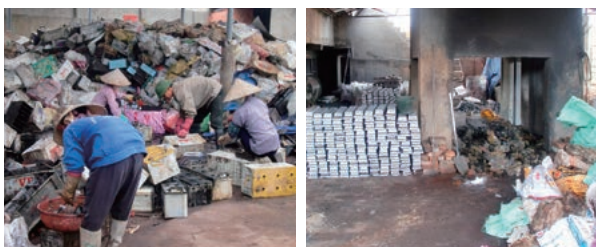
写真1 鉛バッテリーの解体処理と再精錬処理の様子 (ベトナム Dong Mai 村)
