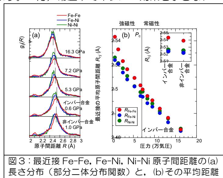
図 3：最近接 Fe-Fe, Fe-Ni, Ni-Ni 原子間距離の(a)長さ分布(部分二体分布関数)と、(b)その平均距離の圧力変化。ここでインバー合金は  $\text{Fe}_{65}\text{Ni}_{35}$  合金、インバー効果を示さない非インバー合金は  $\text{Fe}_{55}\text{Ni}_{45}$  合金に対応する。
