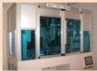
遠藤教授らが開発した、 世界初の全自動タンパク質 合成ロボット「PIM-001」。
