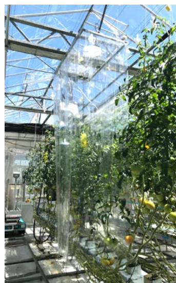
図2 トマト栽培中の農場に設置された光合成蒸散リアルタイム計測システム
