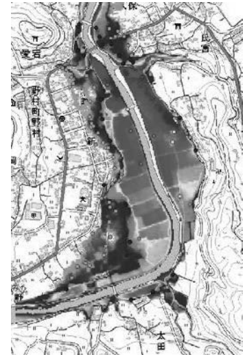
図 2.1.1-8 計算された最大浸水深 (左図) と愛媛大学災害調査団 (川瀬・石黒・藤森・森脇ら) および愛媛県の浸水痕跡調査から得られた浸水深分布 (右図)
