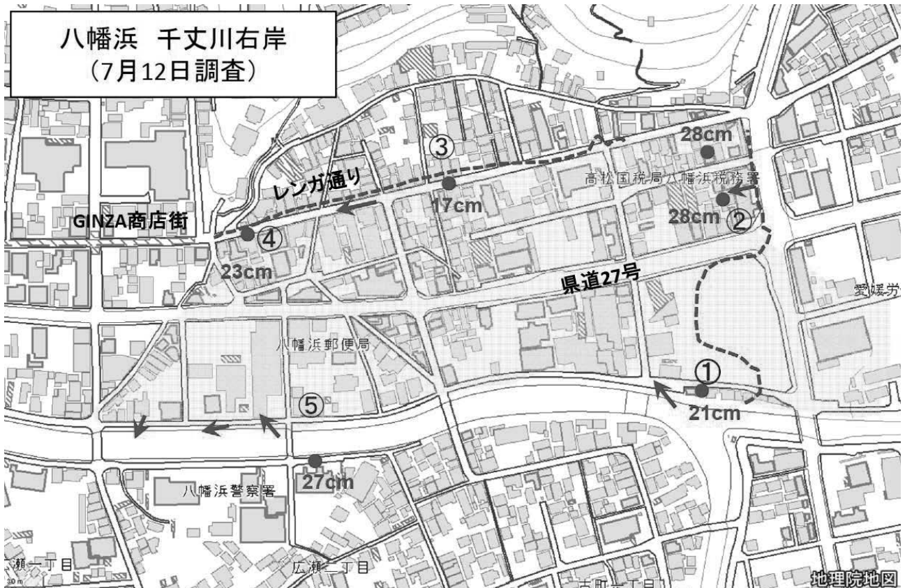
図 2.1.4-21 千丈川右岸の浸水痕跡調査と推定浸水範囲
