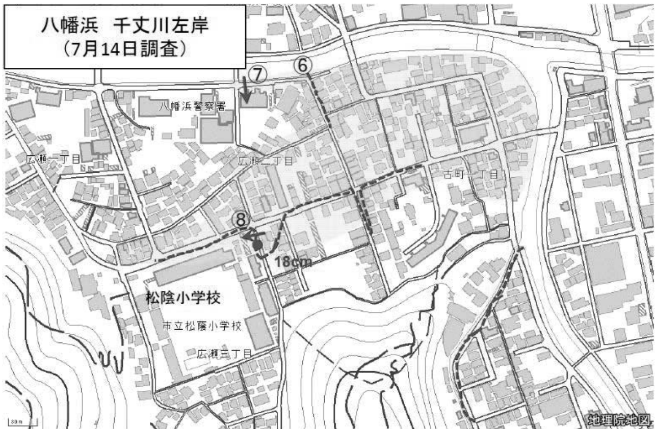
図 2.1.4-22 千丈川右岸の浸水痕跡調査と推定浸水範囲
