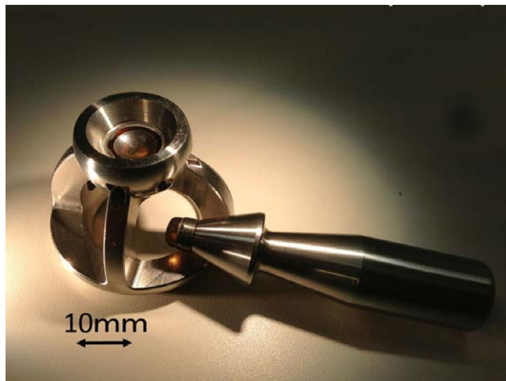
図4 愛媛大学GRC所有のヒメダイヤモンド乳鉢と乳棒。世界最硬の乳鉢・乳棒である。
